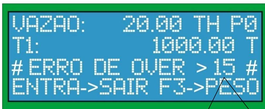
INDICAÇÃO DO ERRO DE OVER CUJA VAZÃO CONFIGURADA COMO FUNDO DE ESCALA É MOSTRADA AO LADO
