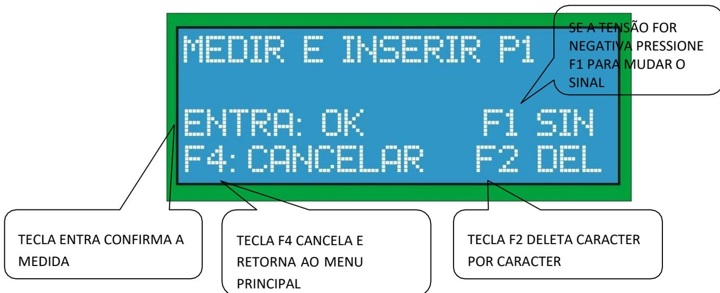
2. Medir a tensão no borne da fonte escolhida para o ponto 2. Por exemplo se a fonte for a 1, medir a tensão no borne F1 entre o + e o -, e inserir a tensão medida na tela abaixo.
