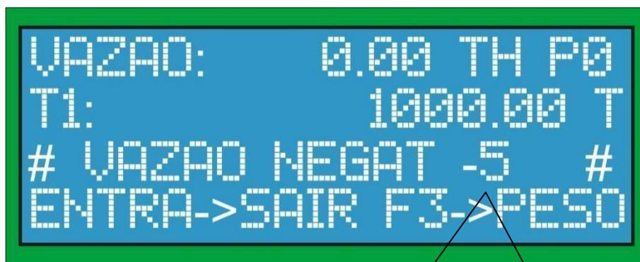
INDICAÇÃO DO ERRO DE VAZÃO NEGATIVA E AO LADO MOSTRA A VAZÃO MEDIDA
