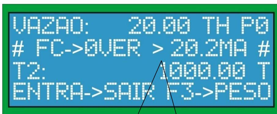
INDICAÇÃO DO ERRO DE FONTE DE CORRENTE SATURADA
