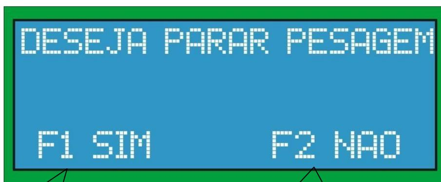
TECLA F1 PARA A PESAGEM E PODE SER FEITO QUALQUER CONFIGURAÇÃO NO MÓDULO
