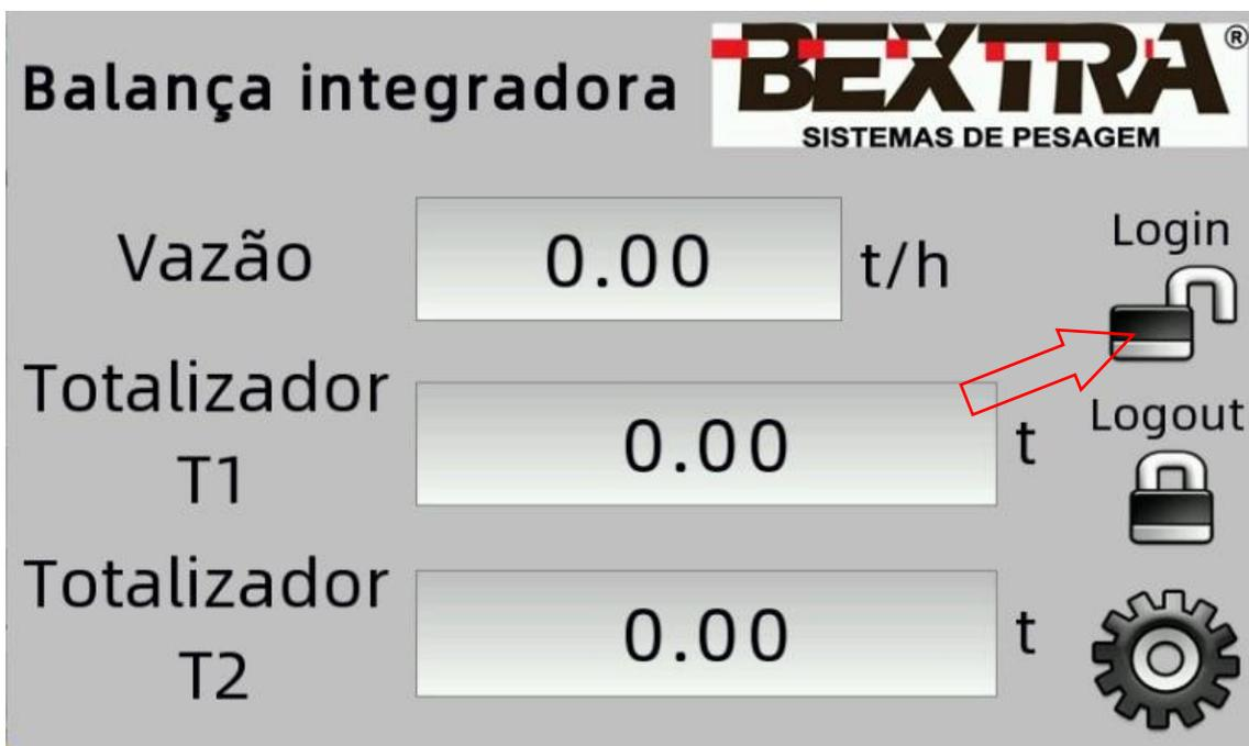
Após 10 minutos do acesso ao menu de configuração e calibração o equipamento automaticamente fará logout, então se for preciso acessar a tela de configuração e calibração será necessário digitar a senha novamente.
