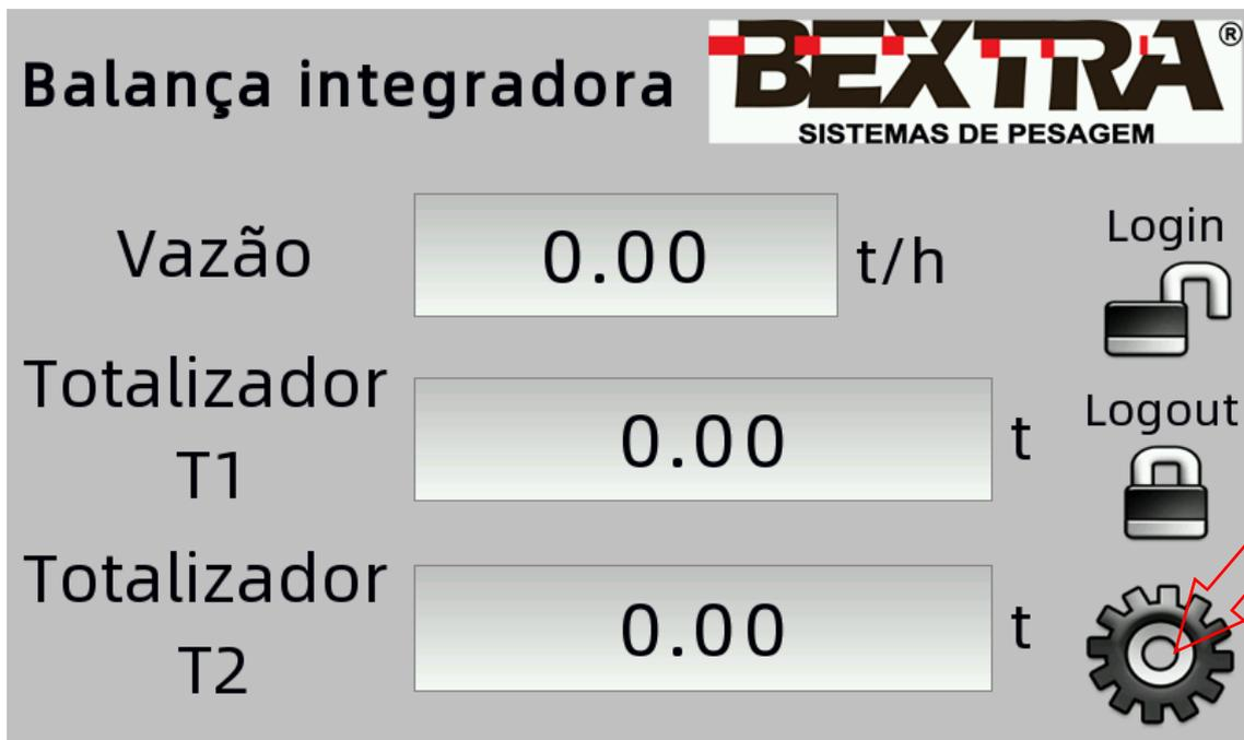
Para uma tara estática podemos utilizar o “Tempo para zero médio” de 2 segundos, quando for necessária uma tara dinâmica devemos medir o tempo de uma volta completa da lona no transportador de correia e inserir este tempo no “Tempo para zero médio”.
