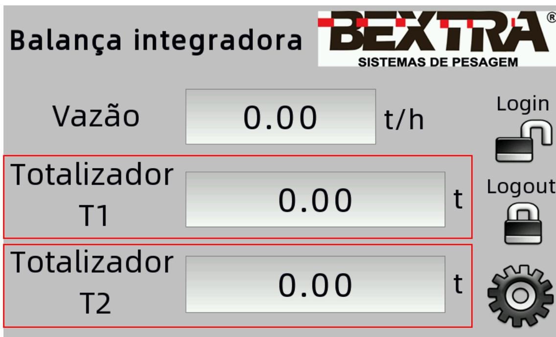
Para zerá-los basta acessar o menu de configuração e calibração clicando na engrenagem e clicar no ícone correspondente a cada totalizador.
