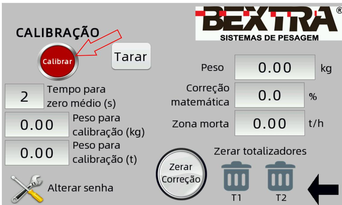
Quando a balança entrar em calibração o botão vermelho mudará levemente de cor e indicará “Em calibração”, além disso logo acima ficará piscando a mensagem “EM CALIBRAÇÃO” e durante o tempo estabelecido para o zero ficará piscando a mensagem “EXECUTANDO ZERO MÉDIO” para indicar que o operador deve esperar o término do zeramento do equipamento.
