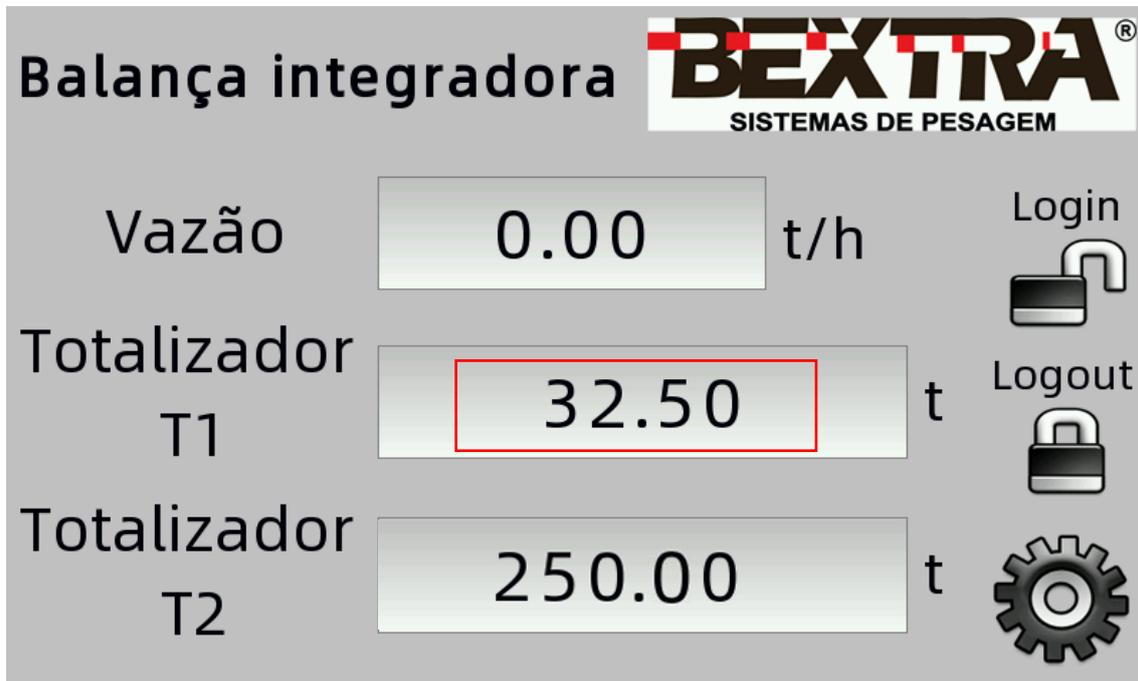
A balança está calibrada dinamicamente e pronta para passar material.
