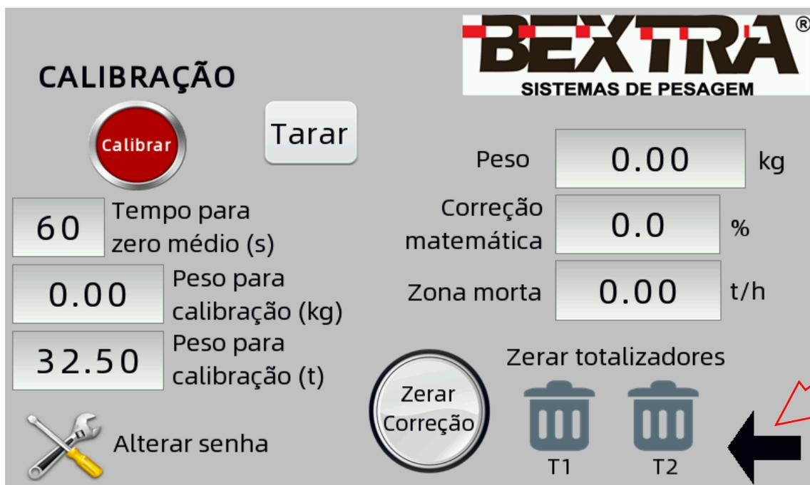
Ao encerrar a calibração o valor inserido no campo “Peso para calibração” será automaticamente atualizado na tela de pesagem no totalizador T1.
