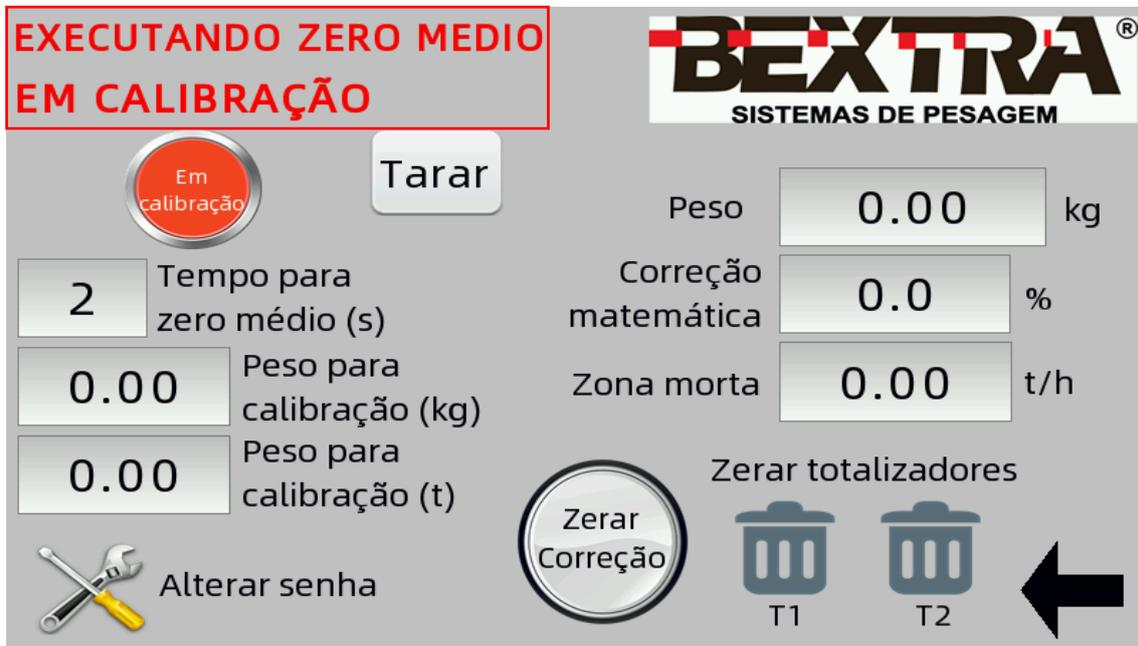
Após a conclusão do tempo do zeramento, deve ser colocado o peso sobre as células de carga na esteira, no centro da área de pesagem e inserir o valor no campo “Peso para calibração (kg)”.
