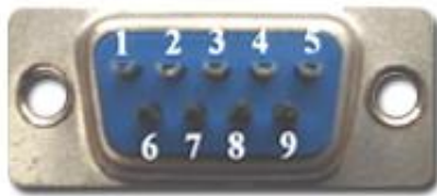
DB9 FÊMEA PARTE TRASEIRA Pontos para solda
