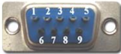
DB9 FÊMEA PARTE TRASEIRA Pontos para solda
