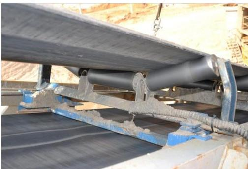
Balança Integradora – ponte de pesagem
